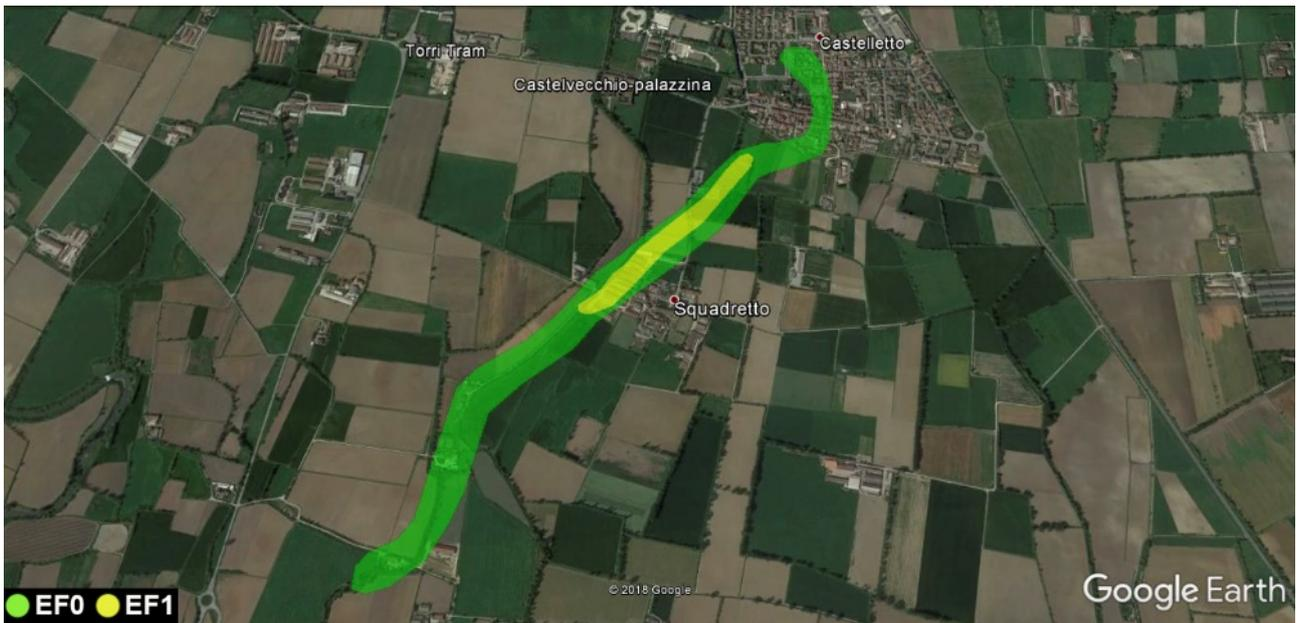
Fig. 4.10 – Isolinee di danno del tornado 3
